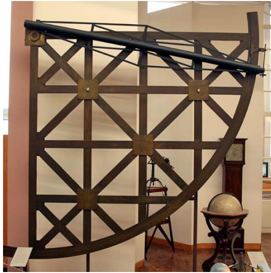
Рис. 6. Квадрант обсерватории. Изготовлен в 1775 г. британским мастером Джоном Бердом.
